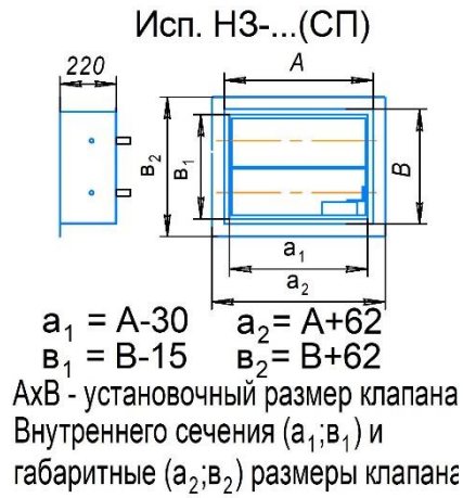
Рис.1. Установочные, габаритные и размеры внутреннего сечения клапана.
